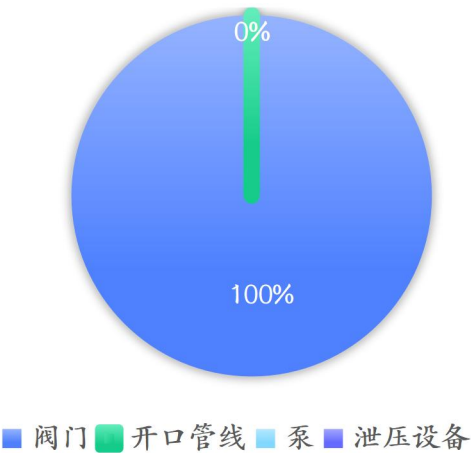
图 7.3-1 2万吨锂离子电池电解液溶剂装置不同组件泄漏情况
